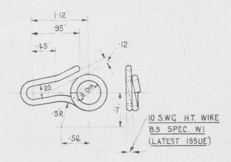
FINISH - TO BE CADMIUM PLATED TO SPEC D.T.D 904 (LATEST ISSUE)
